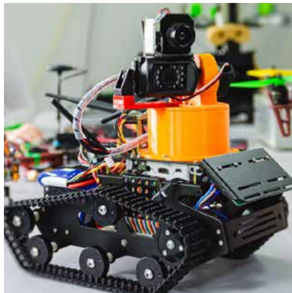
Рис. 1. Інформаційно-вимірювальна система для моніторингу наявності шкідливих та вибухонебезпечних газів та проведення наземної відеозйомки на базі роботизованої гусеничної платформи
